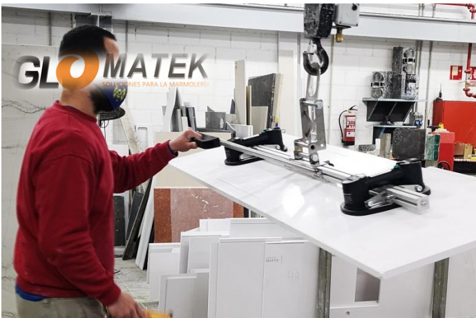
Ejemplo de manipulación con el tablero en horizontal y el asa sin bloquear.
